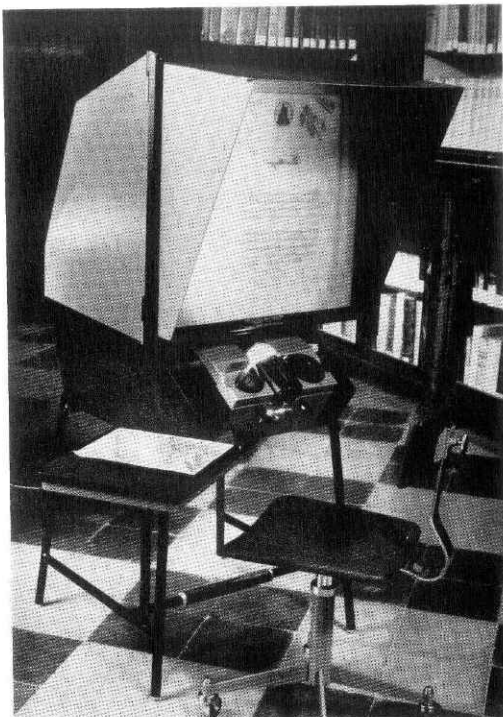
Una delle attrezzature per sussidi visivi della Fardelliana: il microlettore che permette la lettura a forte ingrandimento delle riproduzioni in microfilm di carte e documenti
